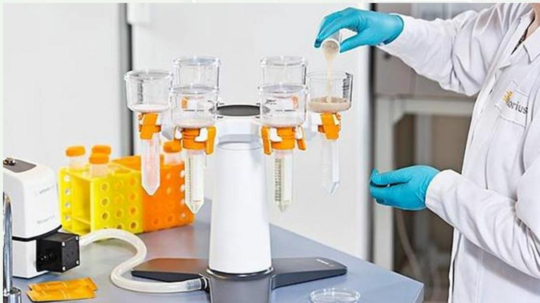
目前已有三千多項關於病毒載體正在進行臨床試驗，其中約 10%是以慢病毒載體進行的。慢病毒載體通常是透過多種質體載體瞬時轉染到 HEK293T 細胞而產生的，病毒會釋放到上清液中，因此要將細胞培養液中的細胞/雜質移除，而在 CAR-T 研究中則是缺乏建立 LV 澄清的黃金方法。常規標準使用以離心機分離再進行上清液微孔濾膜澄清，但是僅透過單一步驟的過濾再加上 DE 助濾劑的輔助，將可有效捕獲和澄清 LV，且提高 LV 純化和 T 細胞轉導效率。
